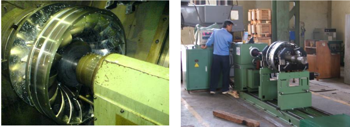
Gambar-8: Pemesinan akhir (kiri) dan penyeimbangan (kanan).
