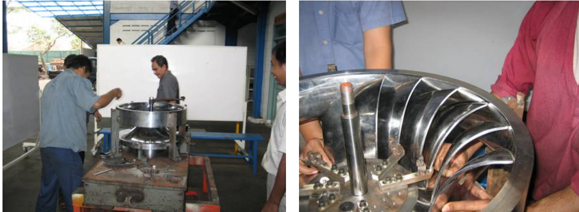
Gambar-6: Pemosisian dan pencekaman cone , ring dan runner sebelum mereka disambung dengan menggunakan proses pengelasan
