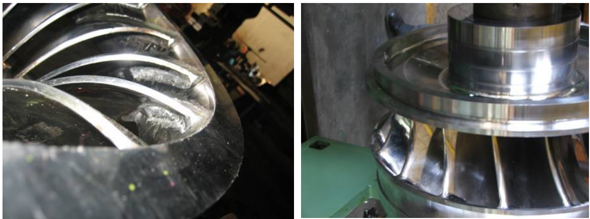
Gambar-7: Hasil pengelasan dan runner yang diperoleh setelah dilakukan penggerindaan hasil pengelasan dengan menggunakan gerinda tangan.
