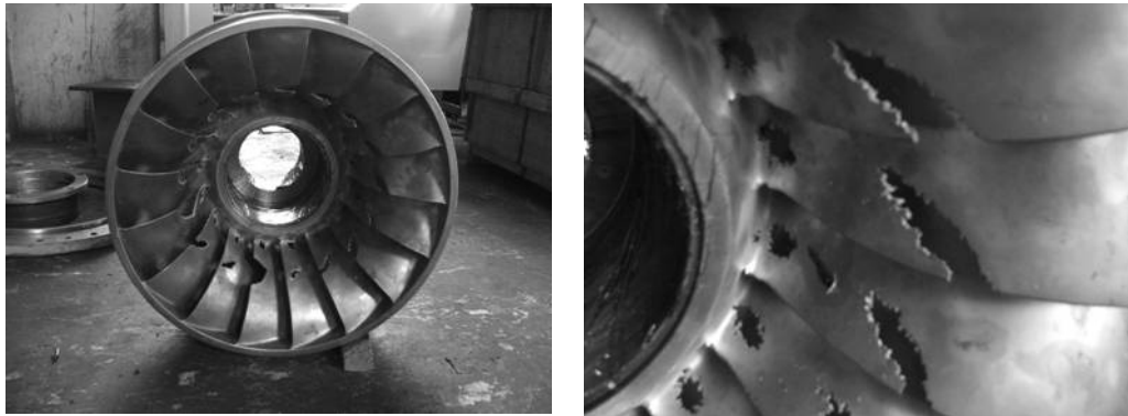
Gambar-2: Kerusakan sudu runner karena abrasi dan kavitasi
