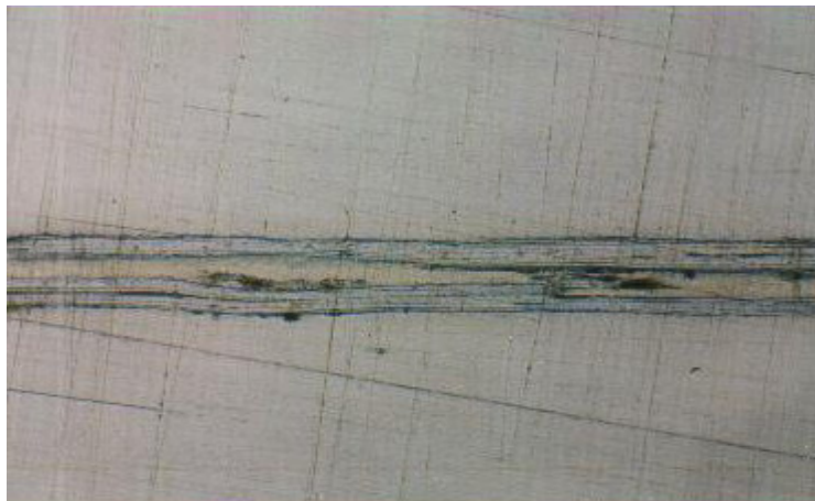
Gambar 10. Foto penampang memanjang komposit serat rami
