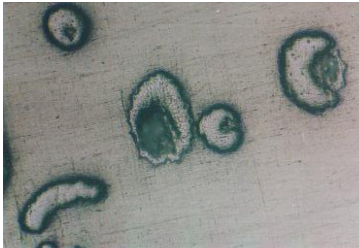
Gambar 9. Foto penampang melintang komposit serat rami
