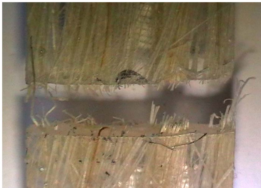
Gambar 11. Foto bentuk patahan komposit serat rami fraksi berat 10%
