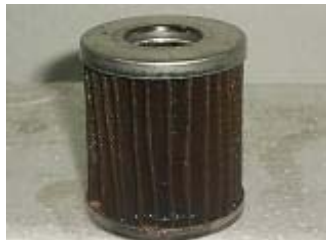
Gambar 5b. Saringan bahan bakar biodiesel sebelum dilarutkan
