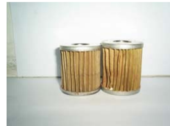
Gambar 5c. Saringan bahan bakar solar dan biodiesel setelah dilarutkan
