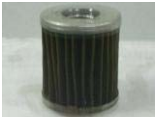
Gambar 5a. Saringan bahan bakar solar sebelum dilarutkan
