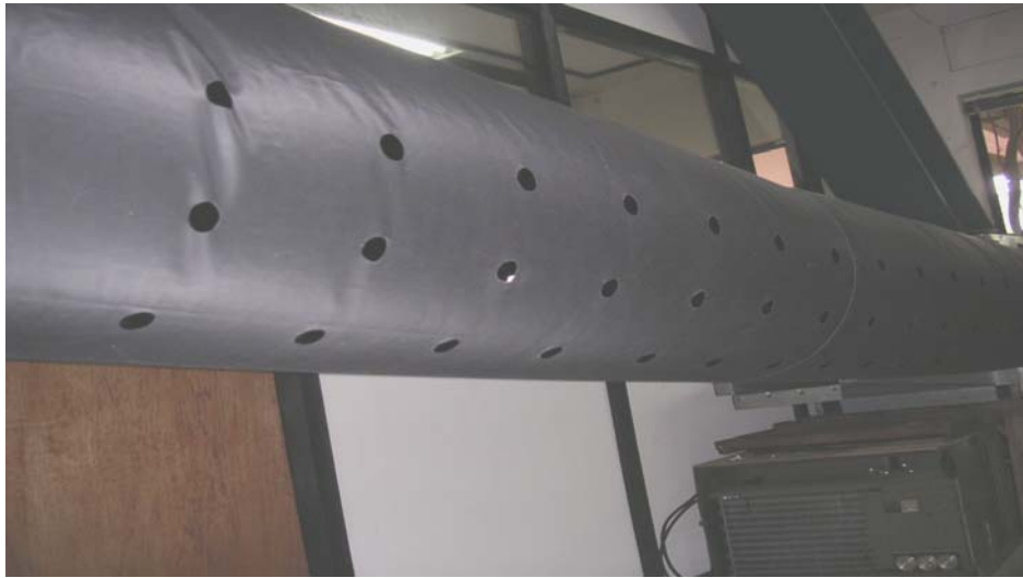
Gb. 3 Susunan orifice pada percobaan textile ducting
