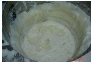
Gambar 6. Ice slurry yang gagal terbentuk dengan aditif cream
