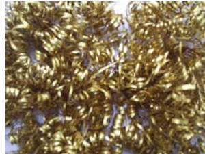
Gambar 5. Kuningan (Cu-Zn, 70 – 30%) sebagai isi muffler straight thru untuk uji
