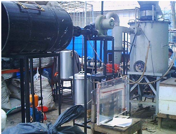
Gambar 3. Pemasangan manometer miring untuk mengukur flowrate produser gas
