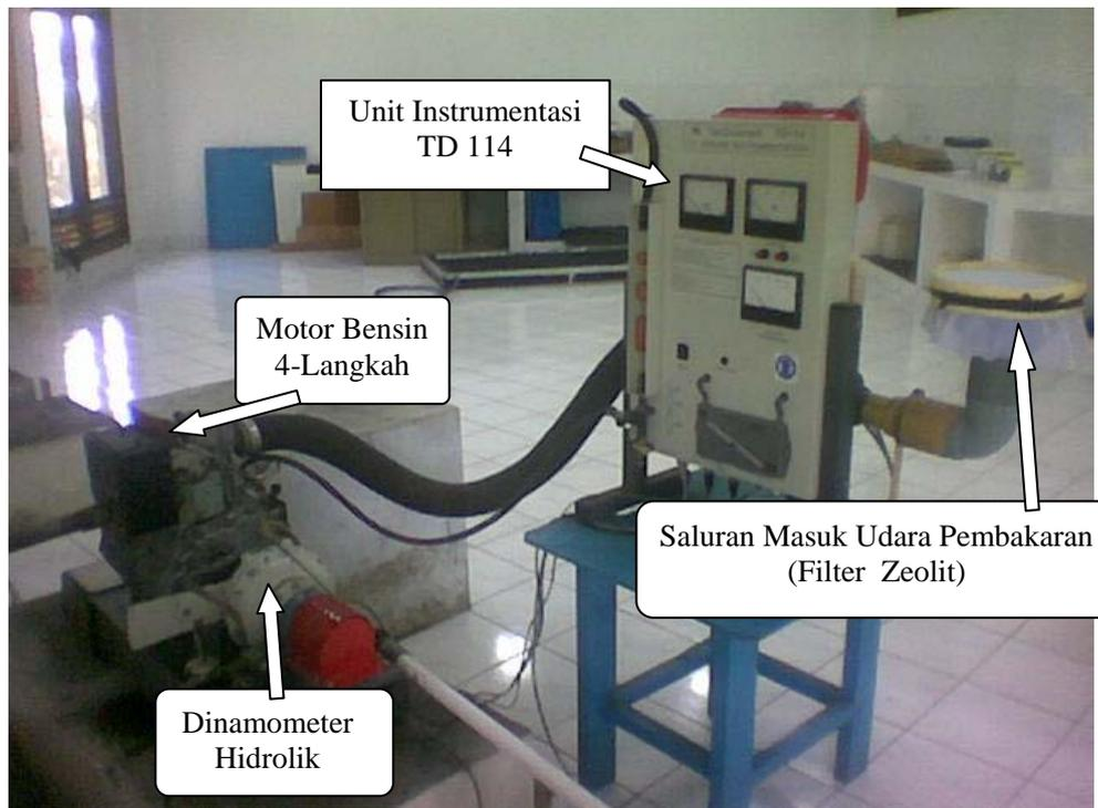
Gambar 1. Instalasi Pengujian Menggunakan Filter Zeolit
