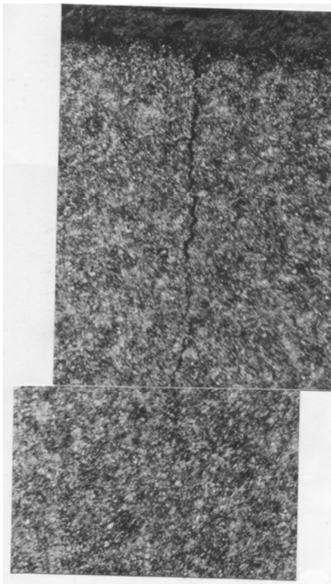
Gambar 10. Retakan pemasukan hidrogen dengan rapat arus 100 mA/cm 2 , waktu 180 menit
