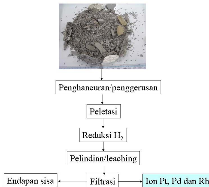
Gbr. 6 Diagram alir salah satu proses daur ulang material aktif Pt, Pd dan Rh.
