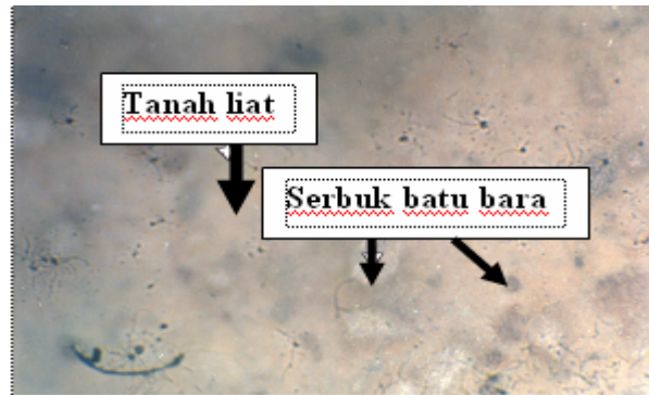
Gambar 4.7. Struktur mikro Campuran tanah liat dan serbuk batubara (200x)
