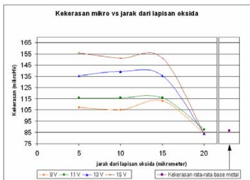
Gambar 1. Grafik nilai kekerasan mikro terhadap jarak dari lapisan oksida
