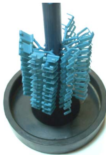
Gambar 1. Pola lilin yang sudah digabungkan dengan pola lilin lainnya
