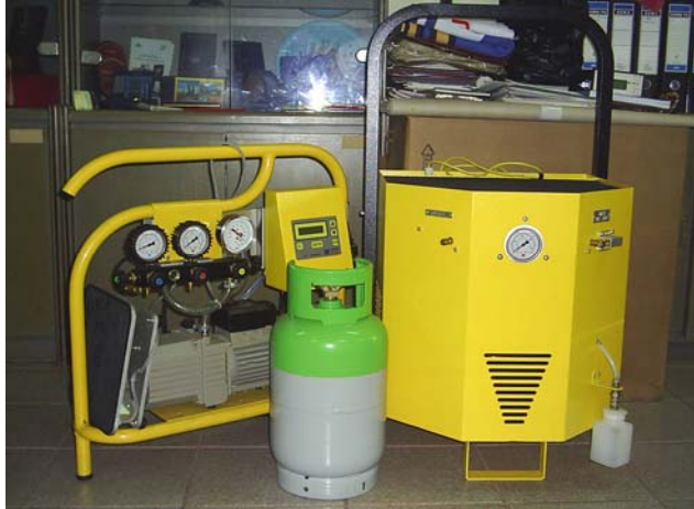
Gambar 4: Mesin Vakum dan Recharge ACS dan Mesin 2R (Recycle and Recovery)
