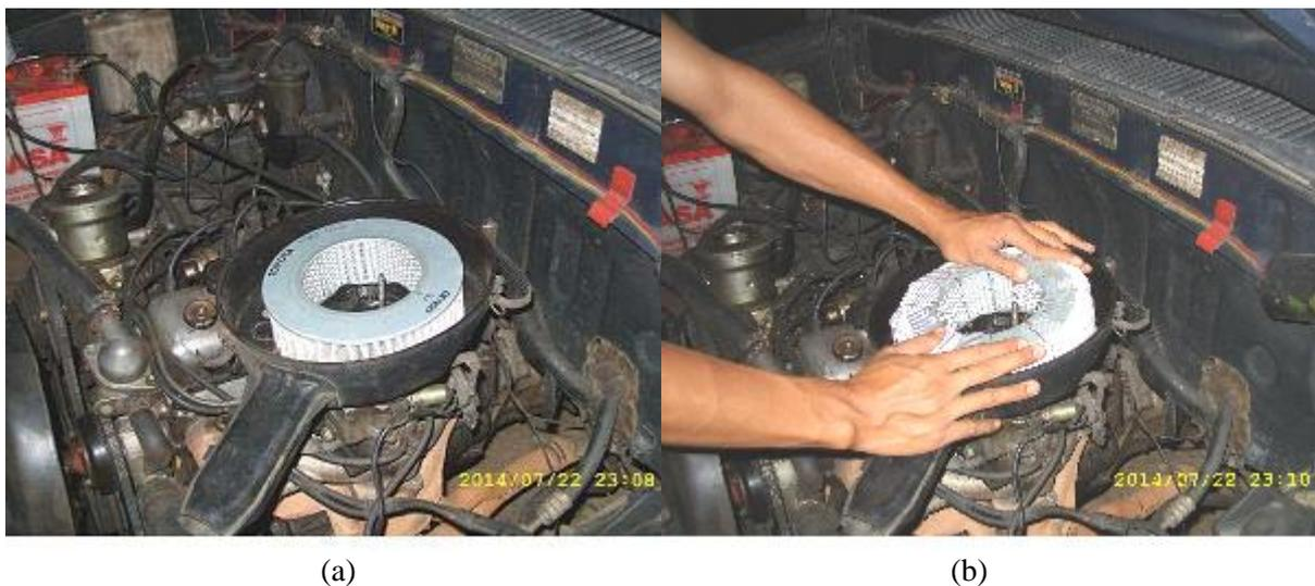
Gambar 1 Saringan udara mobil yang terpasang di rumah saringan: a. Tanpa zeolit, b. Dengan zeolit
