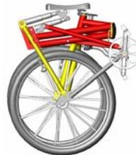
Gambar 5.b Rancangan sepeda yang akan dikembangkan setelah dilipat
