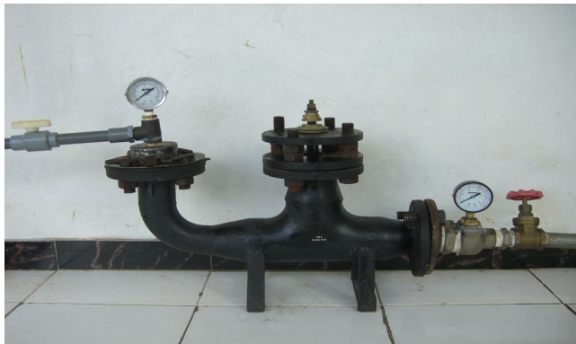
Gambar 4 Rancangan pompa hydram tanpa dan dengan menggunakan tabung udara
