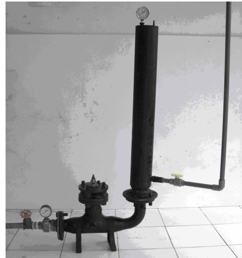
Gambar 4 Rancangan pompa hydram tanpa dan dengan menggunakan tabung udara
