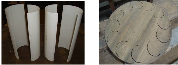
Gambar 5. Sudu ( bucket ) dari pipa PVC dan roda (rim) dari kayu / papan
