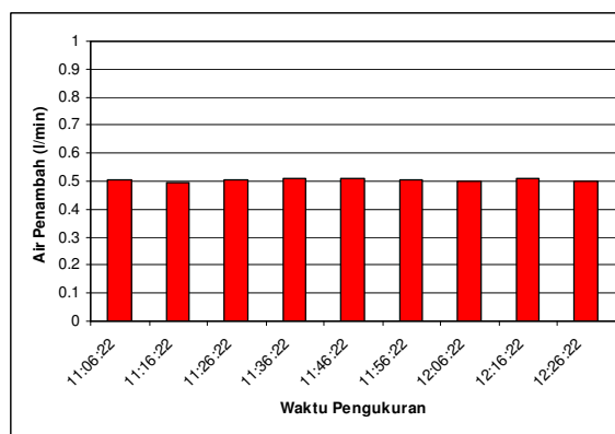
Gambar 12. Konsumsi air penambah pada kondisi aliran panas setelah CT dilengkapi perata aliran
