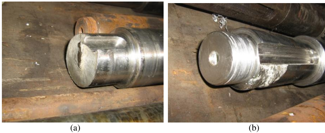
Gambar 3. Kegagalan poros Superduplex (kiri) dan kegagalan poros Hastelloy C-276 (kanan).
