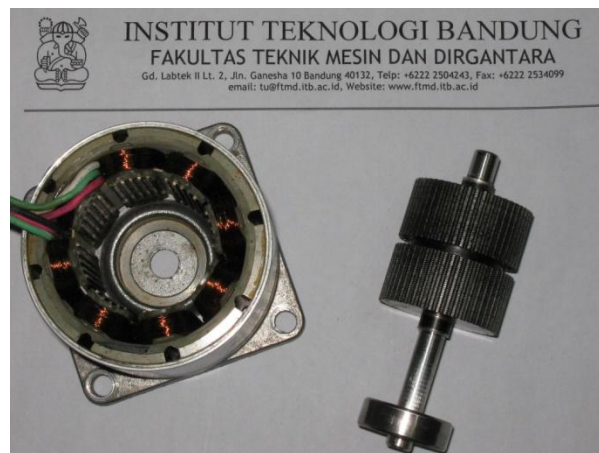
Gambar 8. Bagian dalam motor step
