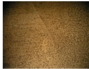
Gambar 10: Struktur Mikro Daerah Transisi Antara Logam Dasar dengan Daerah Las (Posisi 4). Perbesaran 400X dengan etsa nital 1%
