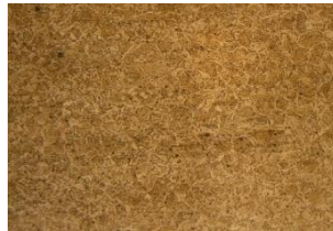
Gambar 9: Struktur Mikro Daerah Las (Posisi 3). Perbesaran 400X dengan etsa nital 1%.
