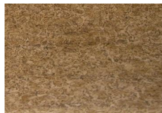
Gambar 7: Struktur Mikro Daerah Logam Dasar (Posisi 1). Perbesaran 400X dengan etsanital 1%.
