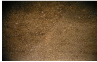
Gambar 8 : Struktur Mikro Daerah Transisi Antara Logam Dasar dengan Daerah Las (Posisi 2). perbesaran 400X dengan etsa nital 1%.
