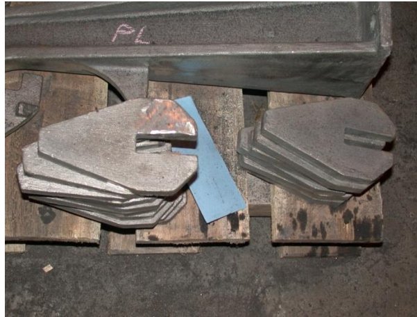
Gambar 10. Komponen Retainer ASTM A-447
