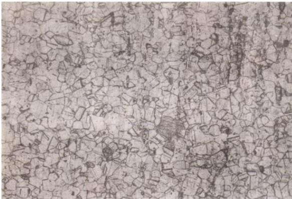
Gambar 1. Struktur mikro baja 316L
