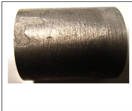
**Gambar 3.4.** Crack pada C-ring dengan pembebanan 36 kg dan direndam didalam larutan NaCl selama 14 hari.
