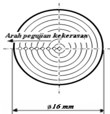
Gambar 5 Jarak dan Arah Pengujian Kekerasan pada Potongan Spesimen Menggunakan Metode Vickers
