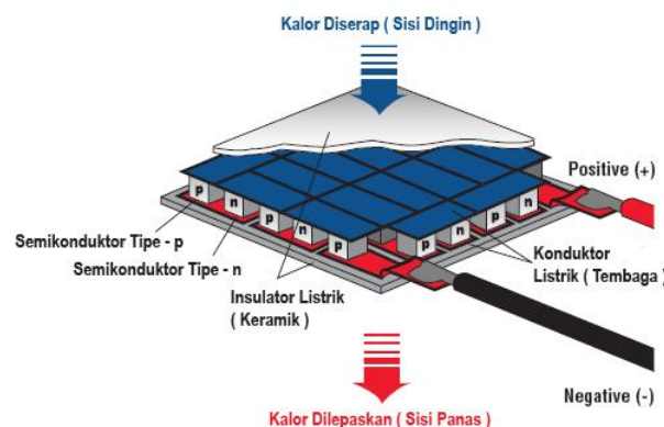
Gambar 1 Skema bagian dari elemen peltier
