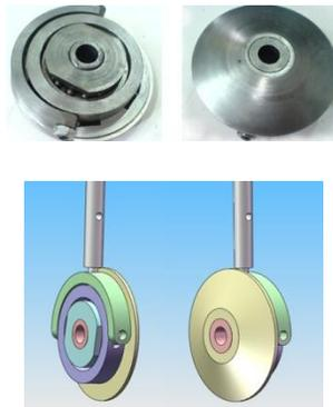
**Gambar 5.** Mekanisme servo pada puli CVT
