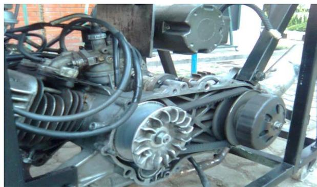
**Gambar 3.** Mesin 4 tak, motor listrik, dengan transmisi CVT pada test-rig
