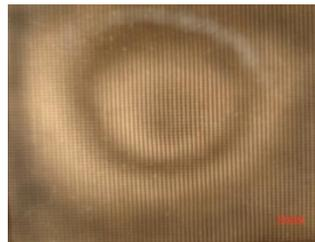
Gambar 11. Pola Moire untuk displacement pada pusat sebesar 1.5 mm
