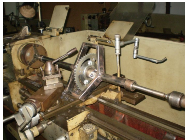
Gambar 10. Proses manufaktur dan pengesetan run-out pada desain gandar sambungan bentuk segiempat
