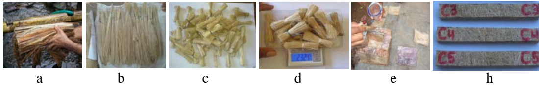
Gambar 1. a). Batang Pisang diserut, b). Serat Pisang, c). Serat yang telah dipotong, d). Penimbangan serat, e). Pencetakan Komposit, f). Spesimen Uji Bending
