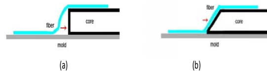
Gambar 3. Modifikasi sisi core . (a) sisi core tegak lurus. (b) sisi core taper
