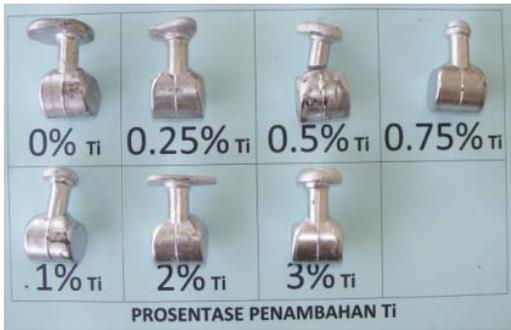
Gambar 2. Spesimen hasil pengecoran
