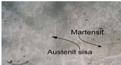
Gambar 4.17. Struktur mikro spesimen profil L posisi pencelupan 5 (PP-5)
