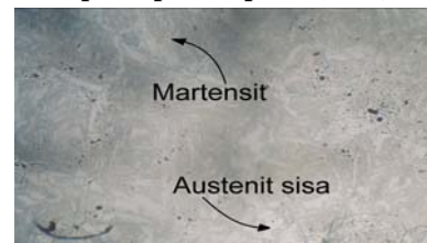
Gambar 4.15. Struktur mikro spesimen profil L posisi pencelupan 3 (PP-3)
