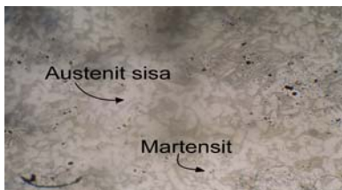
Gambar 4.10. Struktur mikro spesimen profil I posisi pencelupan 1 (PP-1)
