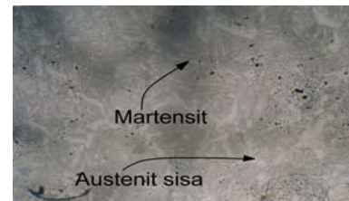
Gambar 4.14. Struktur mikro spesimen profil L posisi pencelupan 2 (PP-2)
