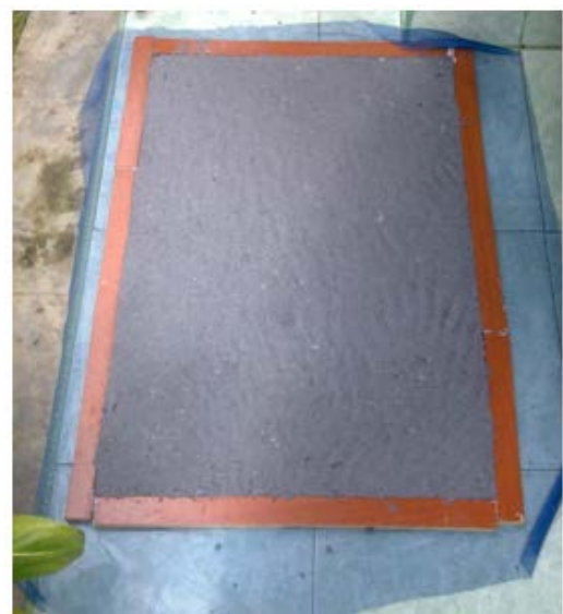
Gbr . 3 Isolator yang terbuat dari bubur kertas koran
