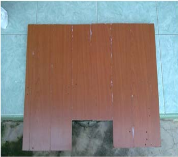
Gbr . 4 Isolator yang terbuat dari serbuk gergajian kayu
