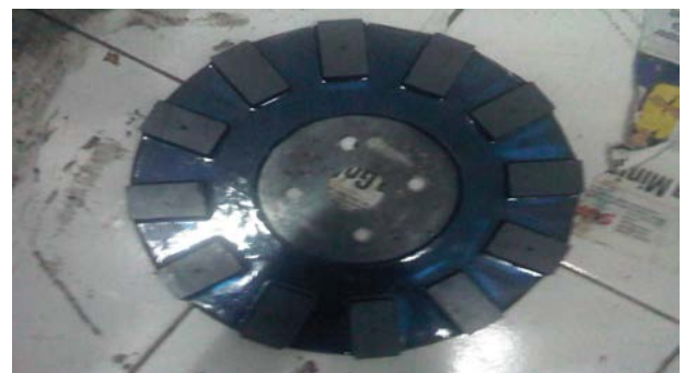
Gambar 6. Rotor dengan 12 magnet [10]
