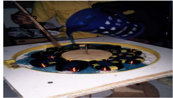
Gambar 4. Penuangan resin pada susunan koil [10]
