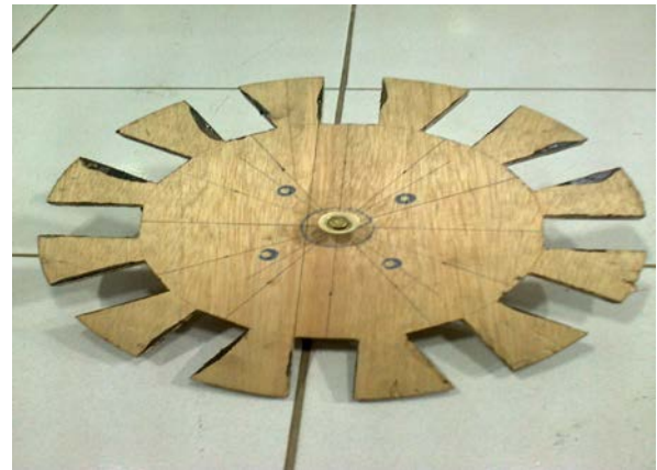
Gambar 5. Jig untuk menempatkan magnet [10]
