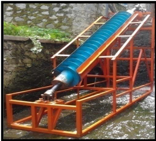
**Gambar 2.** Turbin ulir *archimedes* yang diuji.
