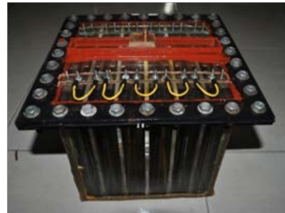
Gambar 1. Prototipe generator gas H_2O_2 jenis wet cell 6 ruang.
