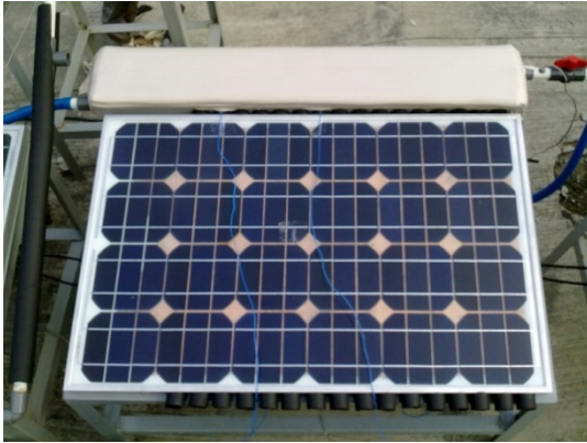
Gambar 3. Sel surya dilengkapi dengan pipa kalor dan alat penukar kalor
