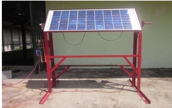
Gambar 7. Panel surya untuk percobaan
