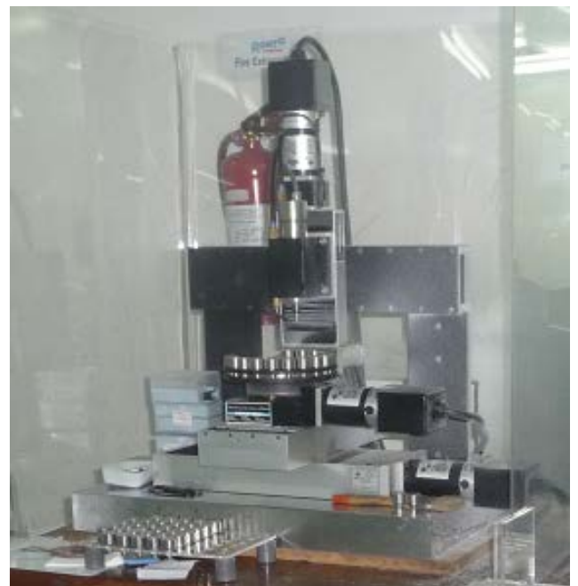
Gambar 10. Prototype Mesin Perkakas Presisi Tinggi dengan teknologi High Speed Machining.
