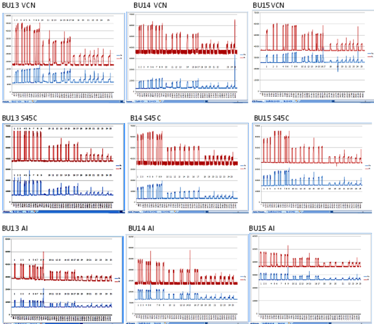
Gambar 2. Karakteristik gaya pemotongan dan gaya makan pada BU13, BU14, dan BU15
