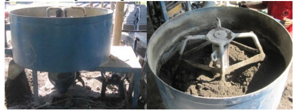
Gambar 2. Proses pencampuran bahan BTPTP pada mesin pengaduk
