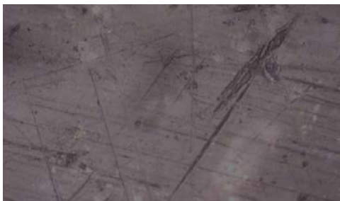
Gambar 5. Foto Mikro Resin Akrilik Tanpa Serat
