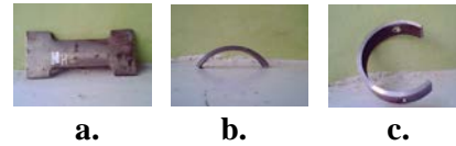
a. Spesimen uji tarik b. Spesimen uji lentur c. Spesimen uji ring C
