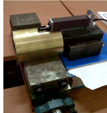
Gambar 3. Pengujian kekasaran permukaan
