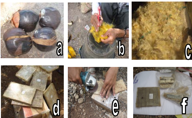
Gambar 1. a. Buah Lontar, b. Pemisahan Serat dari Biji c. Pengeringan, d. Komposit hasil Cetakan, e. Pemotongan Spesimen, f. Spesimen Uji
