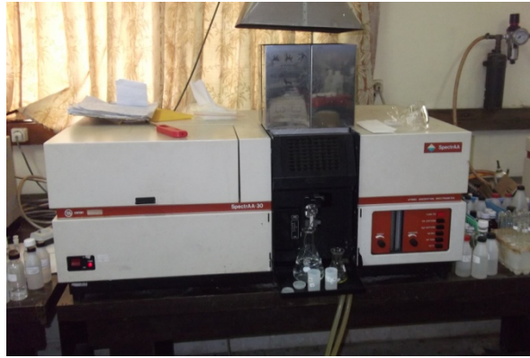
Gambar 3 Peralatan Uji AAS (Milik Lab Analitik, Universitas Udayana)
