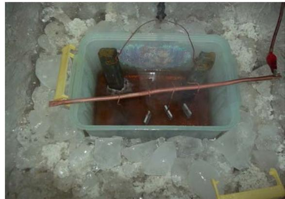
Gambar 3. Foto bejana anodisasi dengan anoda terdiri dari tiga lempeng aluminium.
