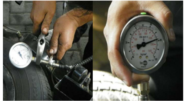
Gambar 6. Foto pengukuran tekanan pada sisi luar brake booster.
